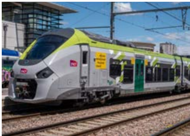
Ces trains peuvent parcourir 200 000 km par an et rouler à une vitesse maximale de 160 km/h. Illustration LBP/A.Delos
